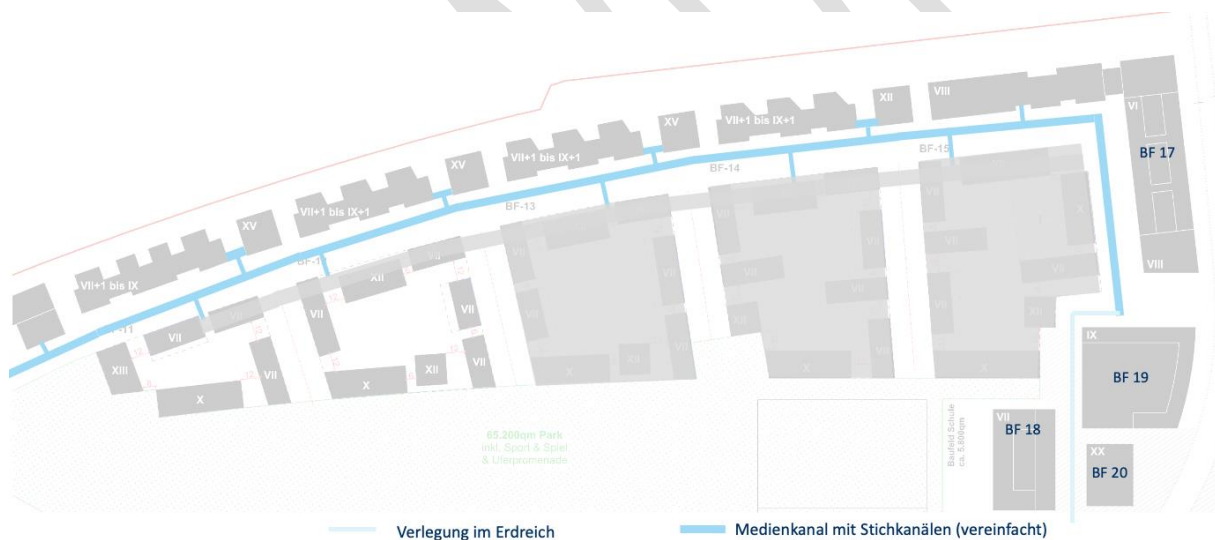
Abbildung 2 - Verlauf der Medienkompaktrasse im Moldauhafenquartier (vereinfachte Darstellung)
