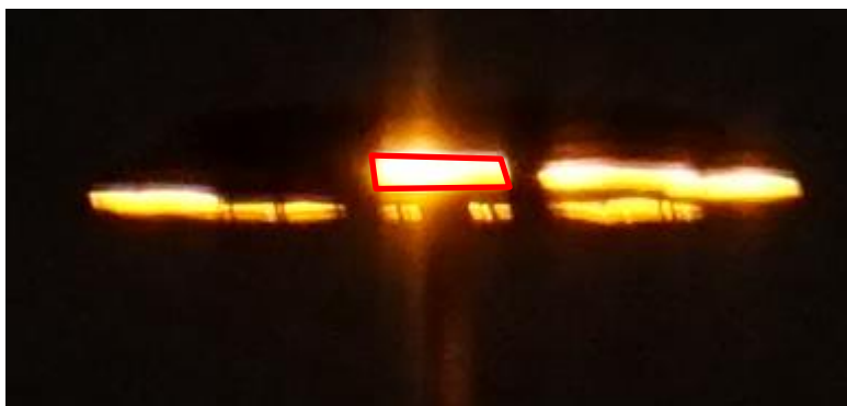
Abbildung 6: Fotografische Ermittlung einer Leuchtfläche
