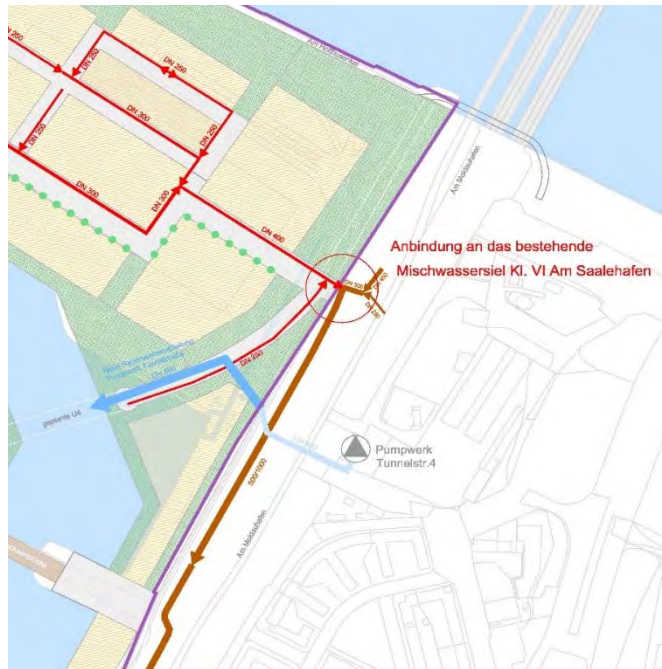
Abbildung 5: Anbindung an das Mischwasser-Siel Am Saalehafen
