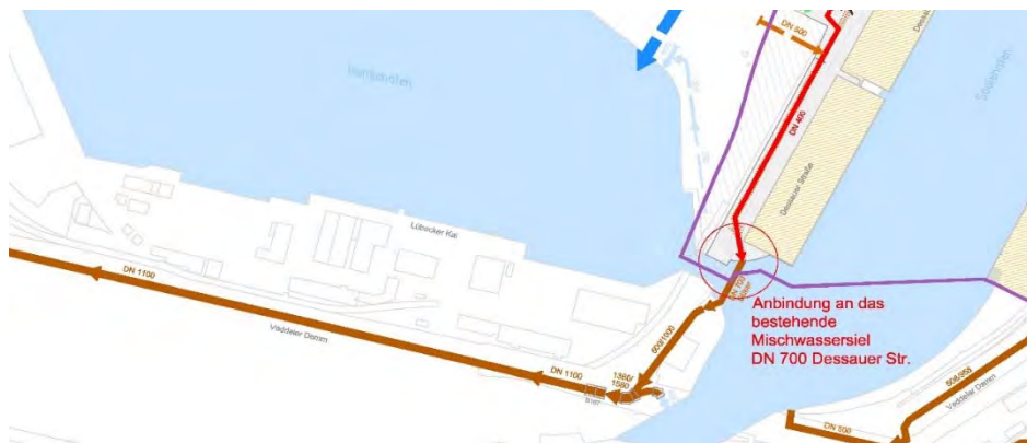
Abbildung 6: Anbindung an die Mischwasser-Siele Dessauer Str. / Veddeler Damm
