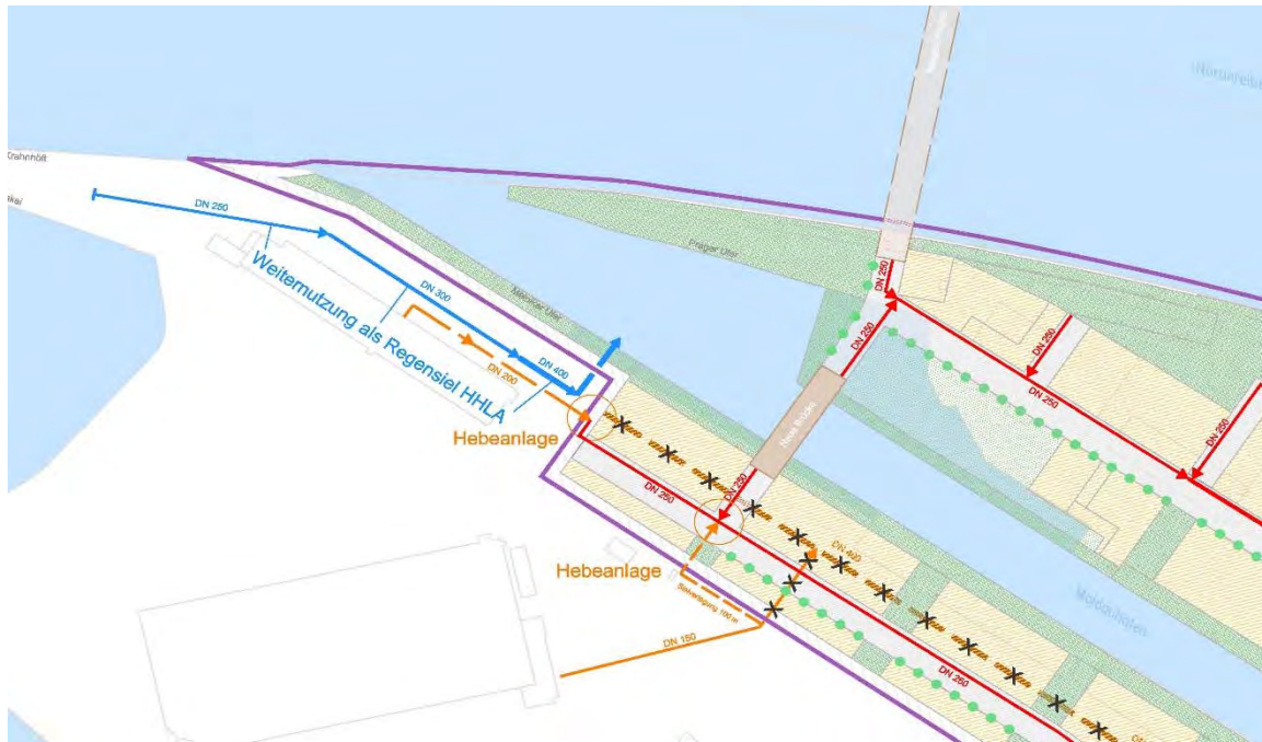
Abbildung 7: Systemtrennung Schmutzwasser / Regenwasser Asiastraße
