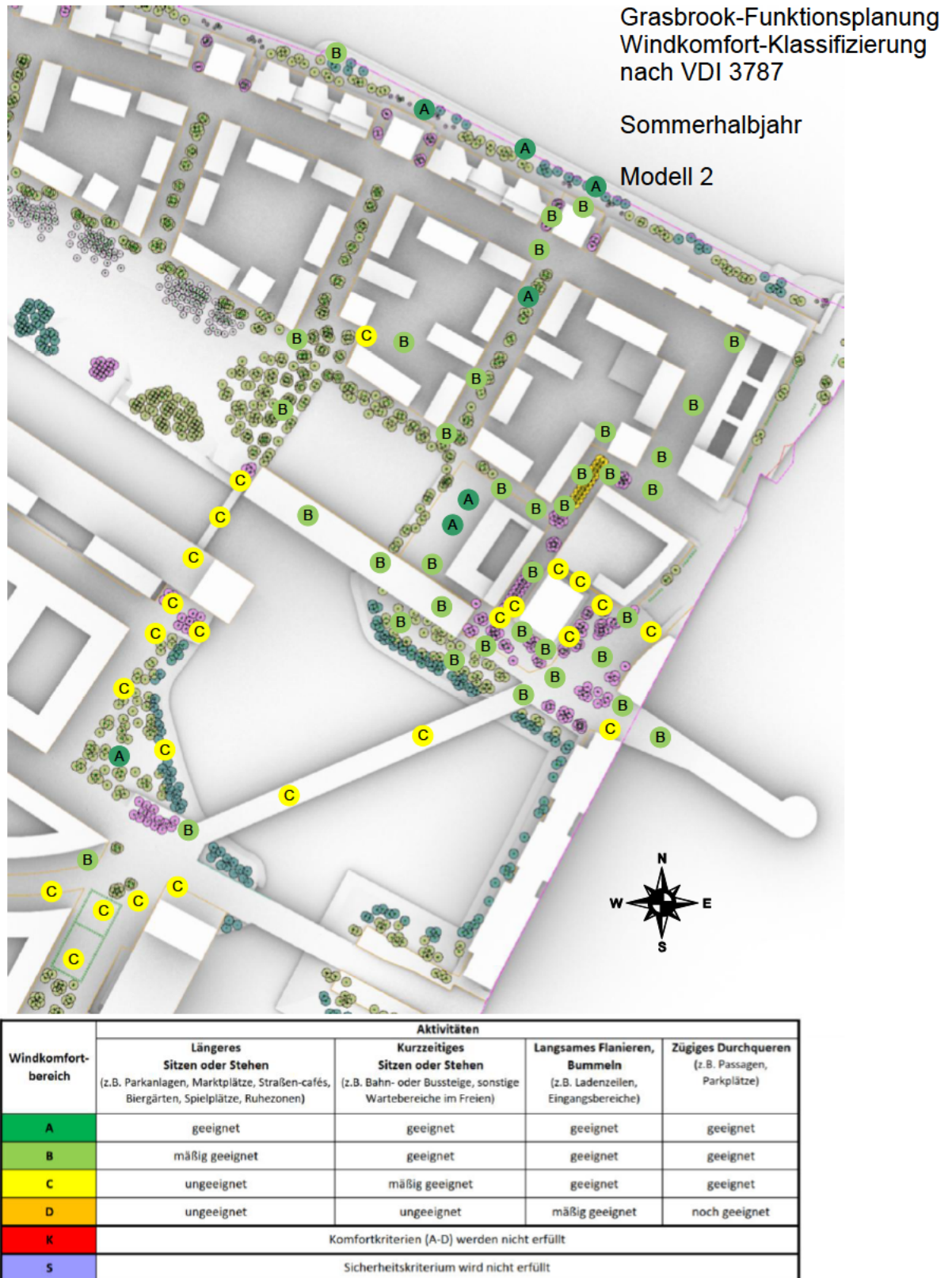
Abb. 3.6: Prognose der Komfortklassen bzw. Nutzungsmöglichkeiten an den einzelnen Messpunkten im bodennahen Außenbereich auf Basis der Klimadaten am Standort sowie der Windkanaluntersuchungen -Klassifizierung nach VDI 3787 Blatt 4 Sommerhalbjahr (April - September) – Bereich Modell 2
