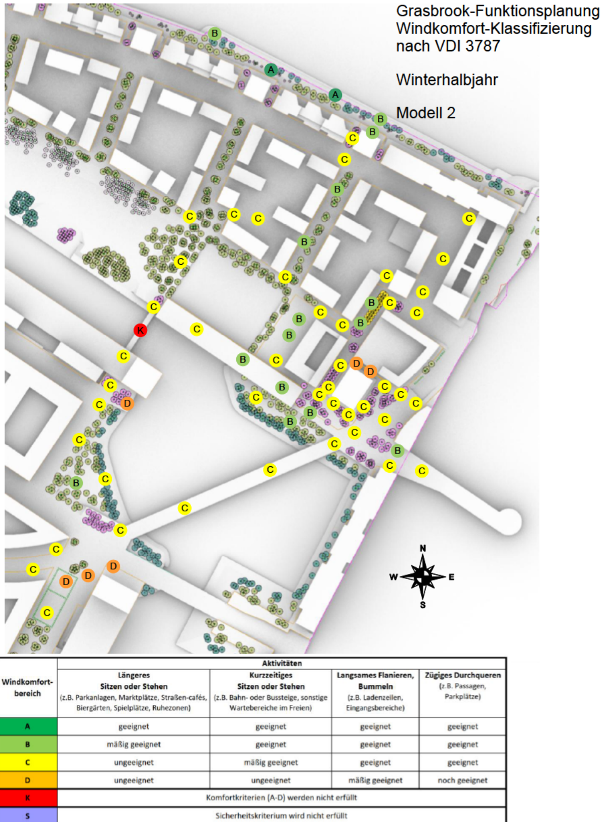
Abb. 3.8: Prognose der Komfortklassen bzw. Nutzungsmöglichkeiten an den einzelnen Messpunkten im bodennahen Außenbereich auf Basis der Klimadaten am Standort sowie der Windkanaluntersuchungen -Klassifizierung nach VDI 3787 Blatt 4 Winterhalbjahr (Oktober - März) – Bereich Modell 2
