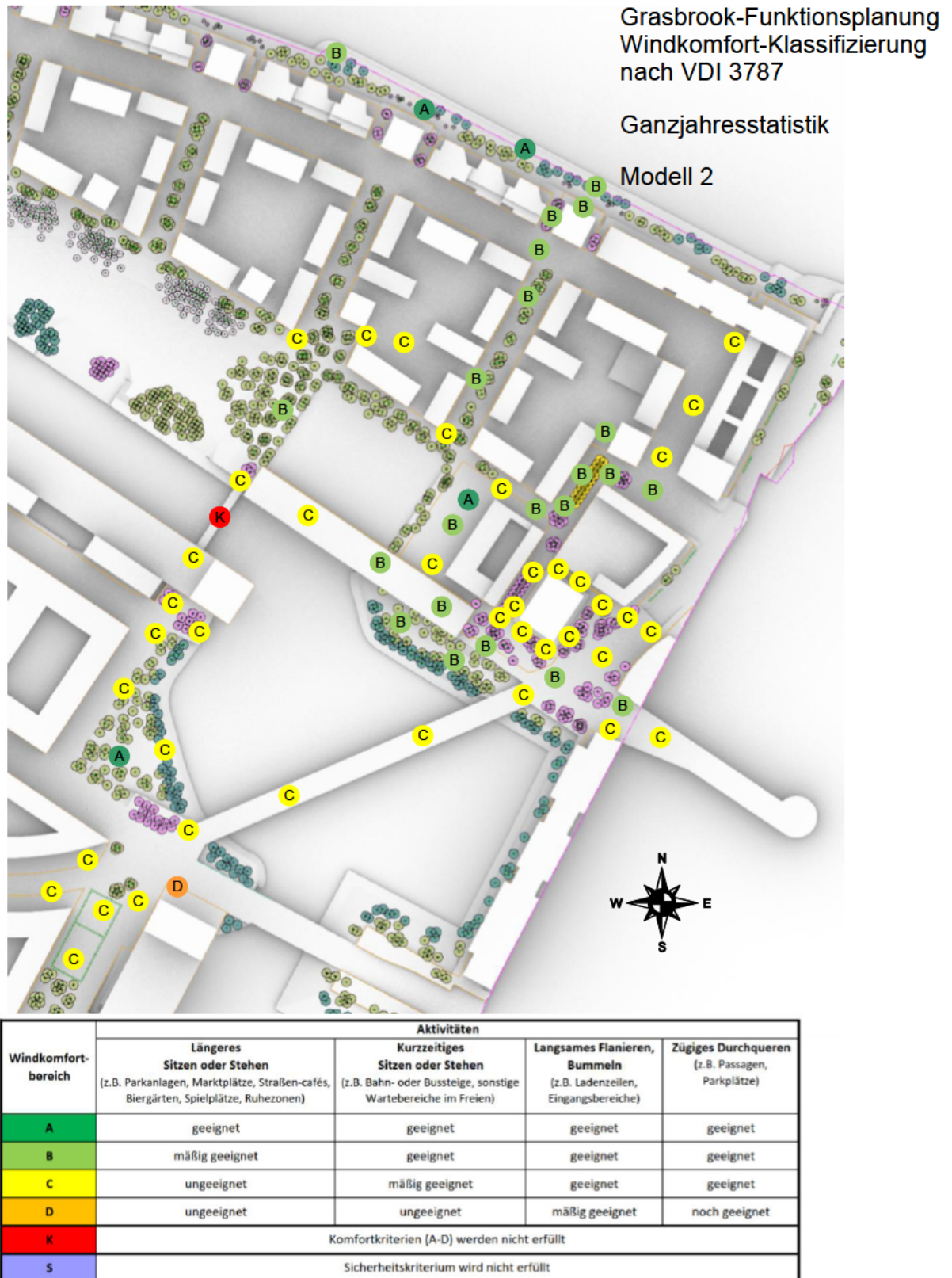
Abb. 3.4: Prognose der Komfortklassen bzw. Nutzungsmöglichkeiten an den einzelnen Messpunkten im bodennahen Außenbereich auf Basis der Klimadaten am Standort sowie der Windkanaluntersuchungen -Klassifizierung nach VDI 3787 Blatt 4 Ganzjahresstatistik – Bereich Modell 2
