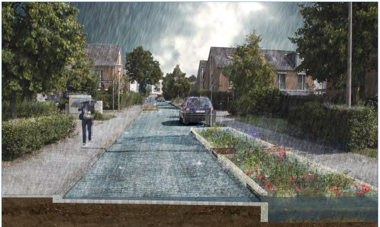
Abb. 69: Beispiellösung A - Entwässerung über Tiefbeete
