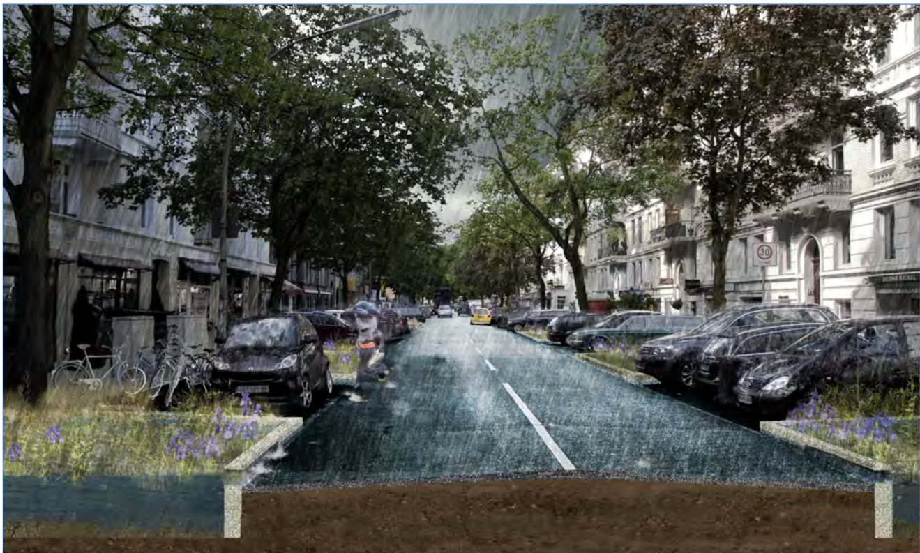
Abb. 48: Beispiellösung A - Entwässerung über Tiefbeete
