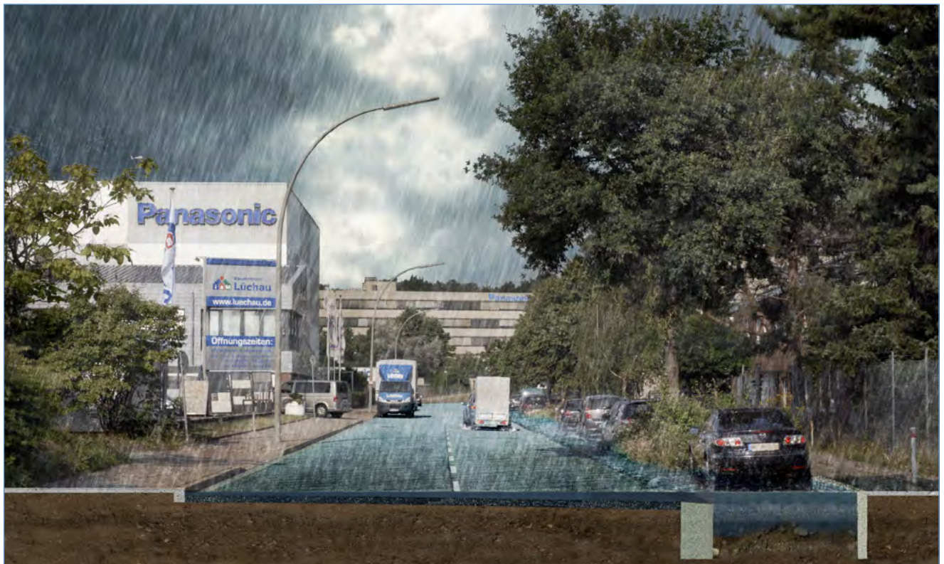
Abb. 55: Beispiellösung A - Entwässerung über Stellplatzstreifen in Tieflage
