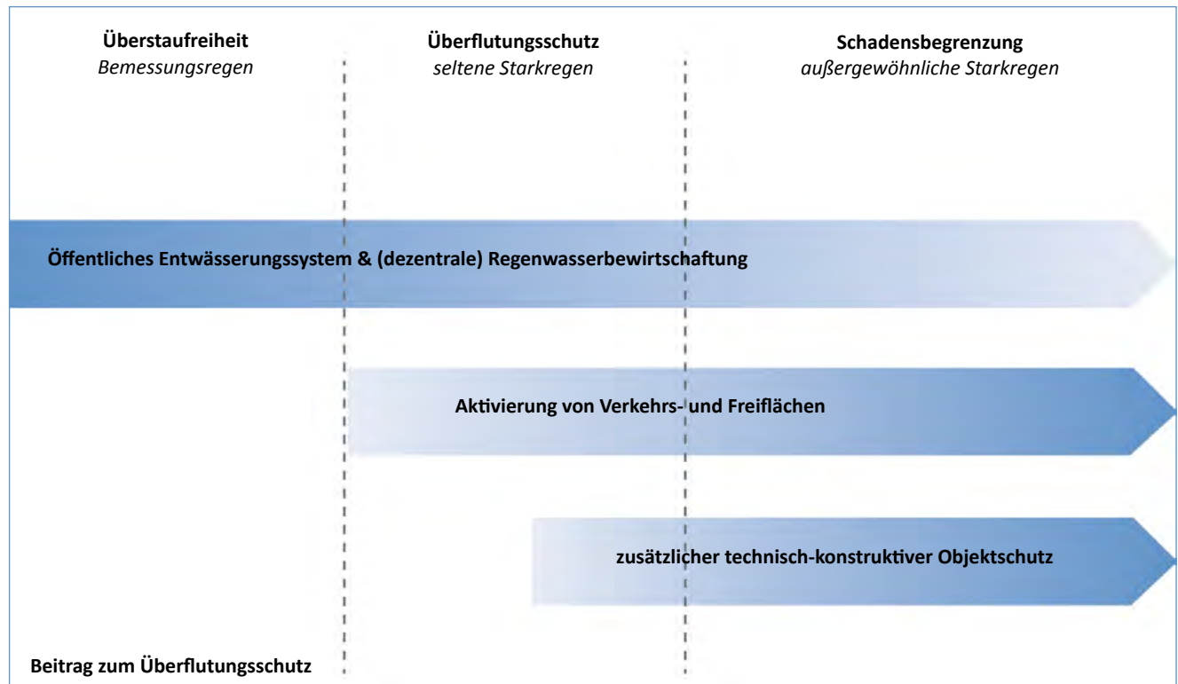
Abb. 5: Elemente des Überflutungsschutzes in unterschiedlichen Belastungsbereichen
