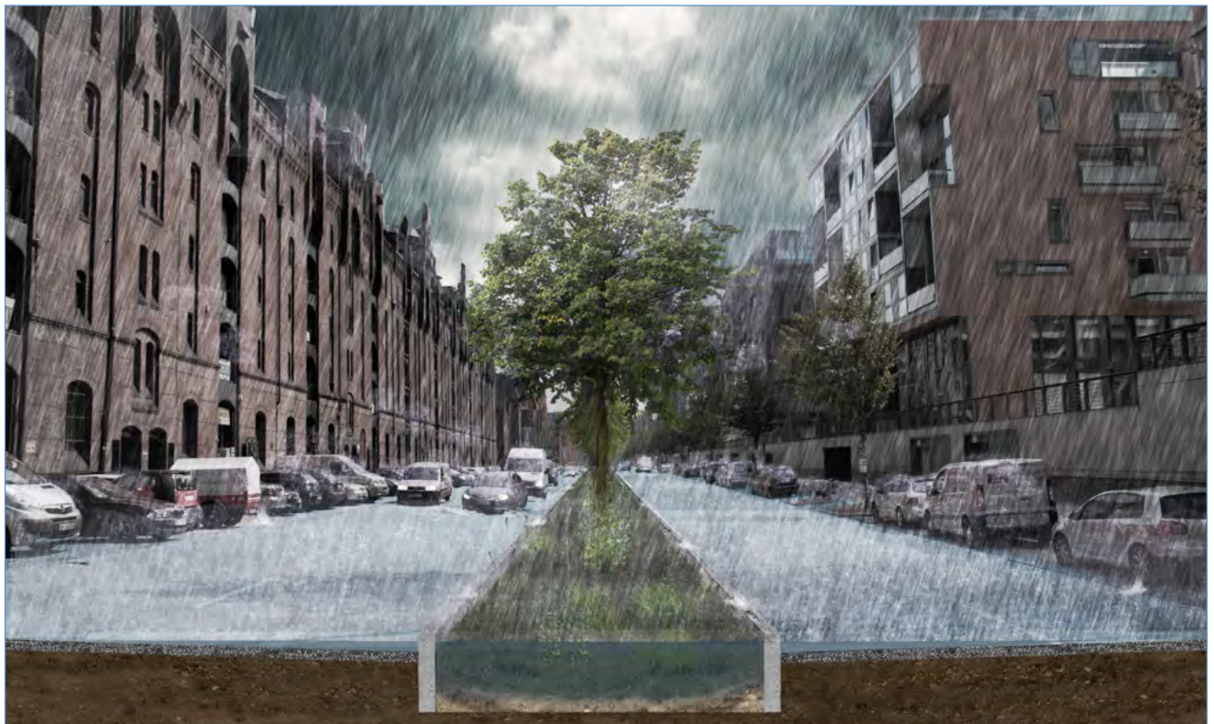
Abb. 41: Beispiellösung A - Entwässerung über Versickerungsmulde im Mittelstreifen
