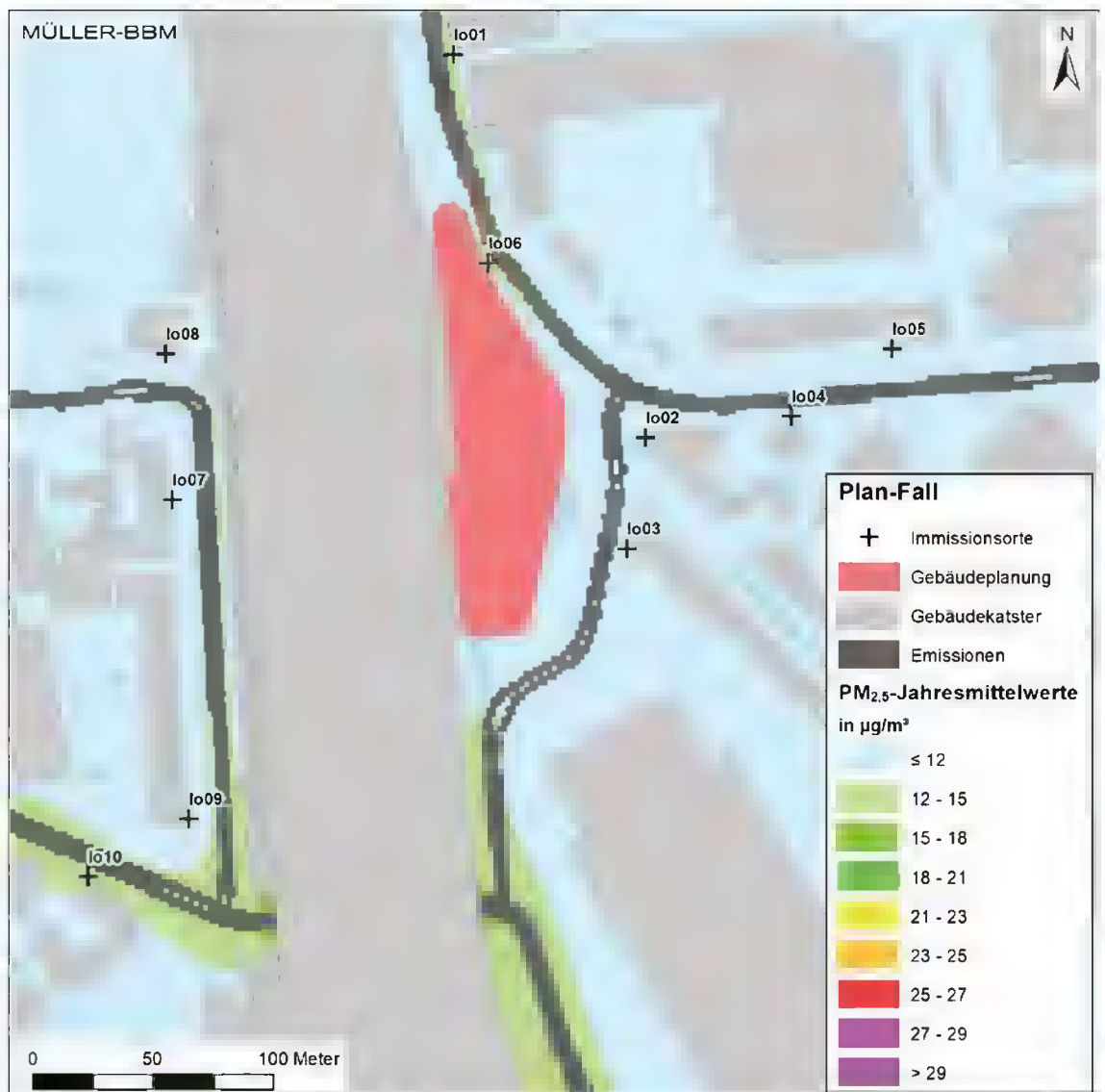
Abbildung 17. Bodennahe PM 2,5 -Immissionskonzentration (Jahresmittel), Luftschicht von 1,2 m bis 1,8 m über Grund – Prognoseplanfall 2025. Kartengrundlage: [16].
