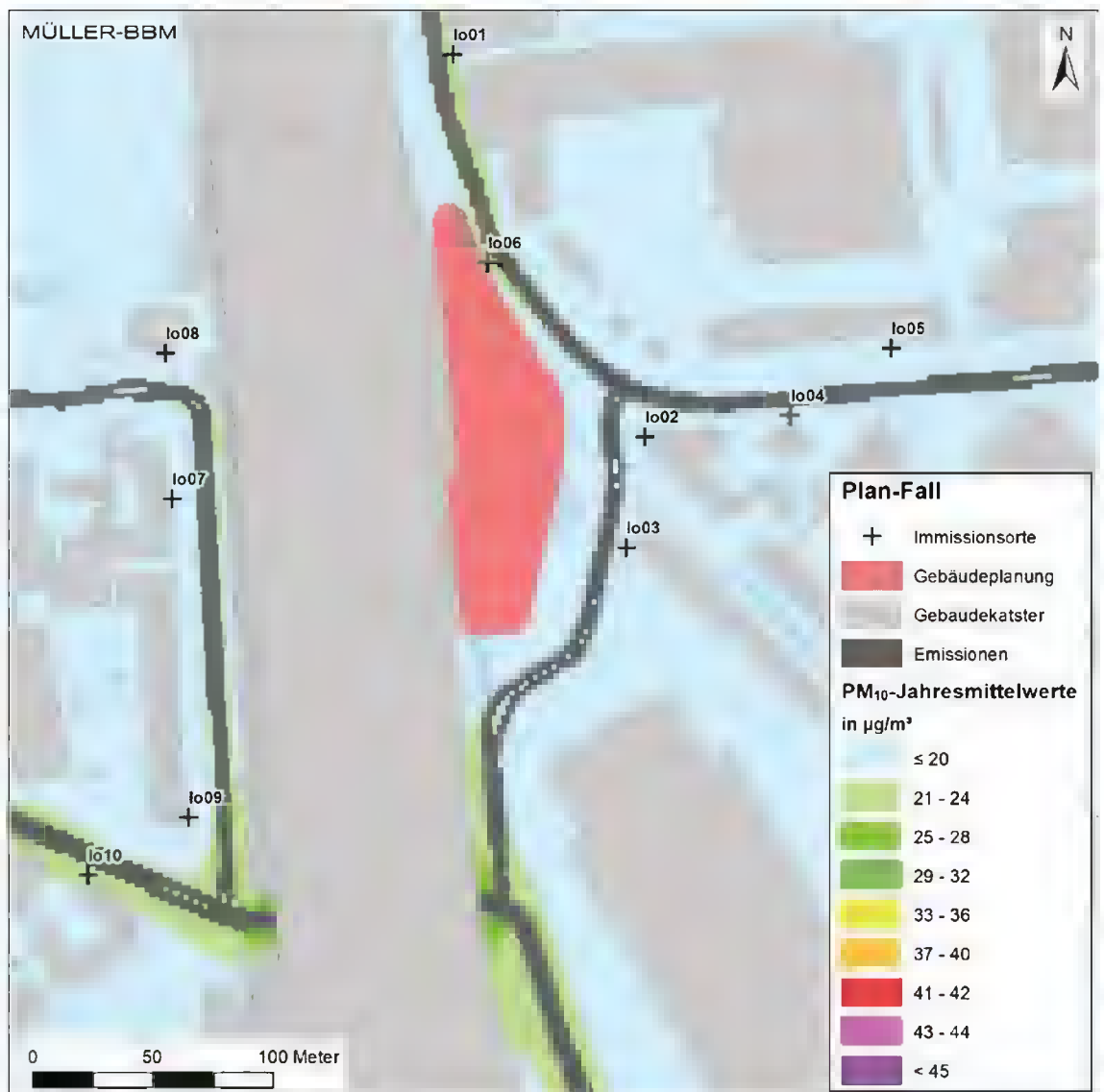
Abbildung 15. Bodennahe PM 10 -Immissionskonzentration (Jahresmittel), Luftschicht von 1,2 m bis 1,8 m über Grund – Prognoseplanfall 2025. Kartengrundlage: [16].
