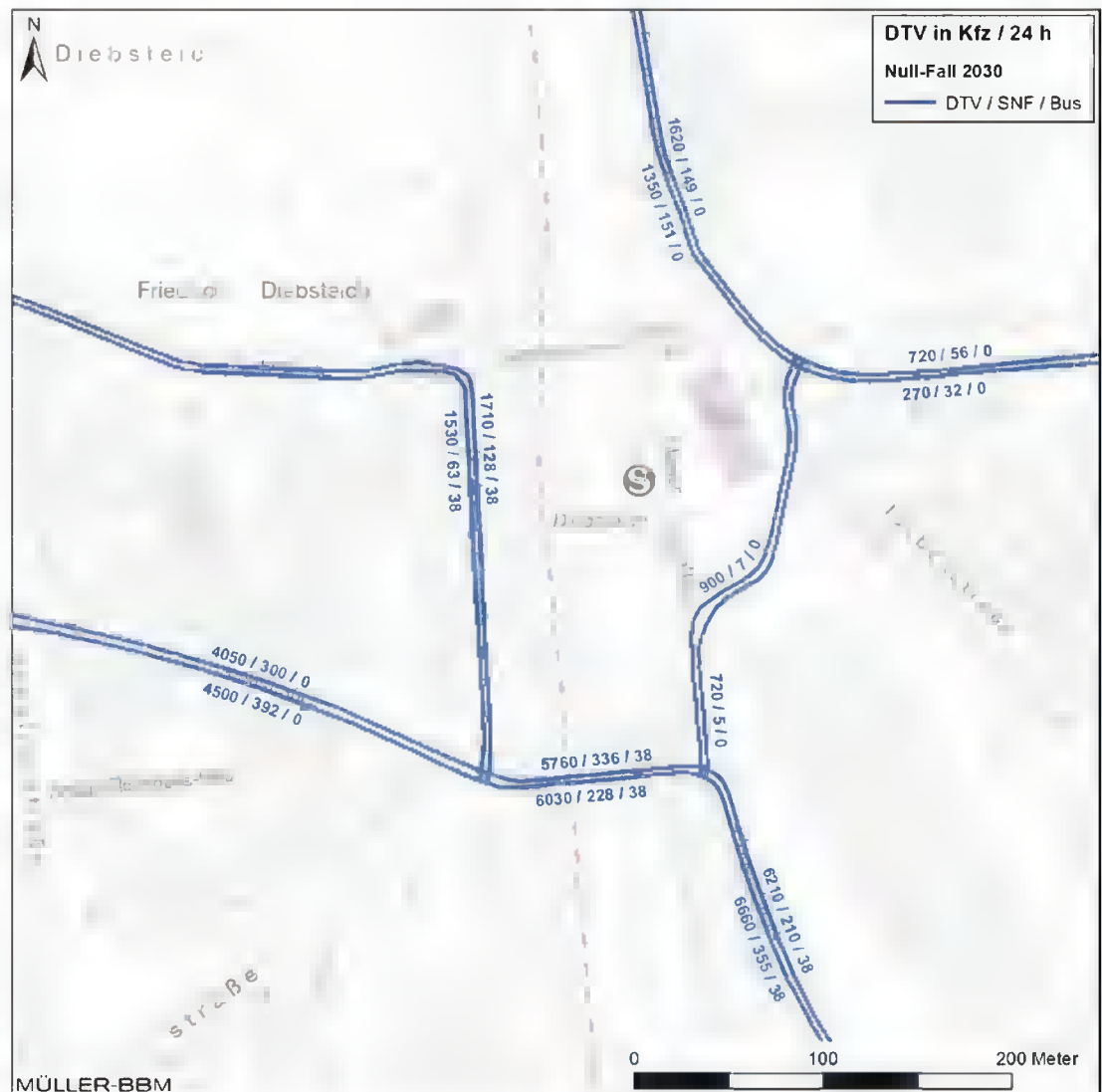
Abbildung 4. Durchschnittliche tägliche Verkehrsstärke DTV, schwere Nutzfahrzeuge (SNF) und Busse in Kfz/24 h im Prognosenullfall der Entwicklungsstufe 2 für das Jahr 2030. Kartengrundlage: [16].
